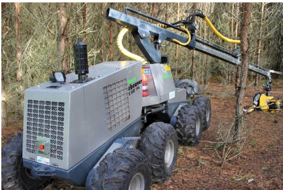
Figura 2.1: Castor florestal equipado como ceifeira para bioenergia com uma cabeça de corte de Kesla.
